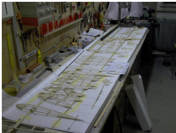
Selbsterstellter sehr einfacher Tragflächenplan und Bau in der Styrohelling.
