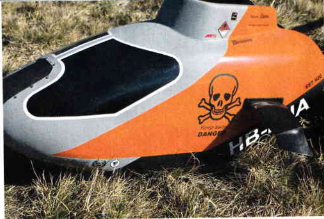
Für die Haube wurde zunächst ein Ur-Modell erstellt, das anschließend in Glasfaser laminiert wurde.
