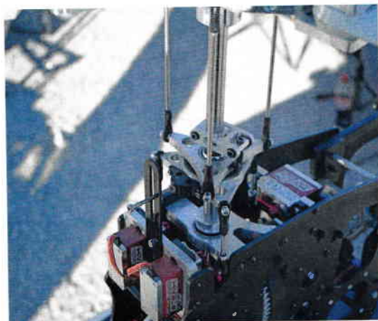
Hochwertige MKS-Servos und die CNC-gefräste Taumelscheibe garantieren eine präzise Steuerung.
