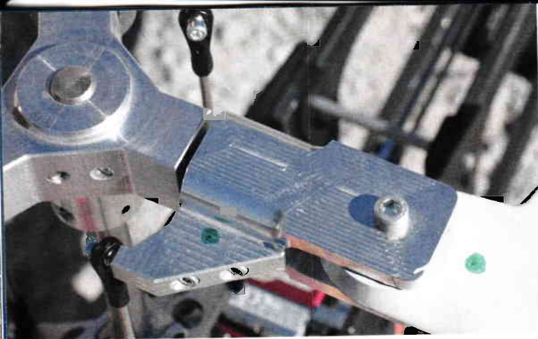
Die Blatthalter sind aus dem Vollen gefertigt.
