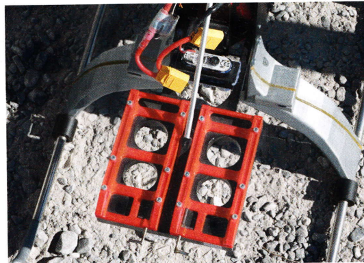
Die roten, 3D-gedruckten Akkuschielen mit Stahlstift-Verriegelung und das verstärkte Landegestell zeigen, wie Sicherheit und Design bei diesem Eigenbau perfekt zusammenspielen.
